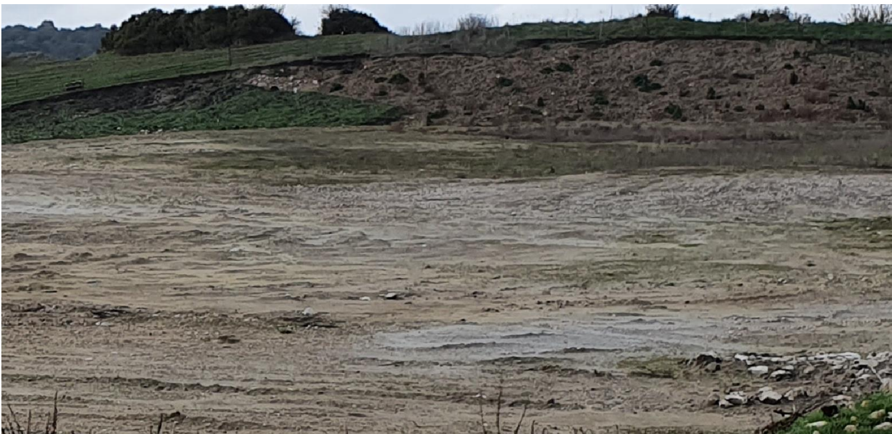
Figura 13: misto di ciottolame conglomeratico ed argilliti sul piano del vecchio scavo
